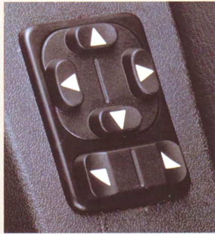
Turbo Injectionin peilejä ohjataan sähköisesti auton sisältä.
